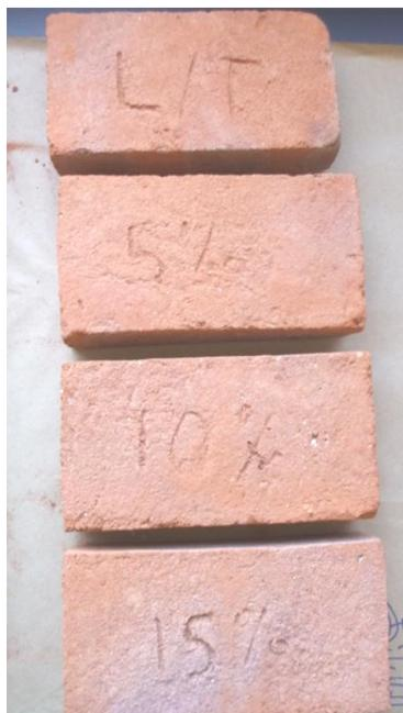
Figura 1. Fotografia que mostra alguns tijolos sinterizados.
