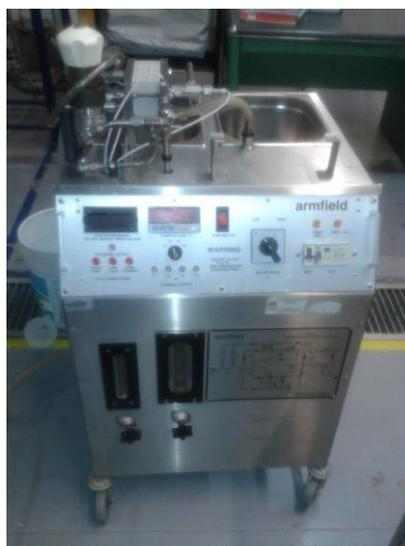
**Figura 5.** Unidad de Ultrafiltración/Ósmosis inversa RO/UF FT18 Armfield
